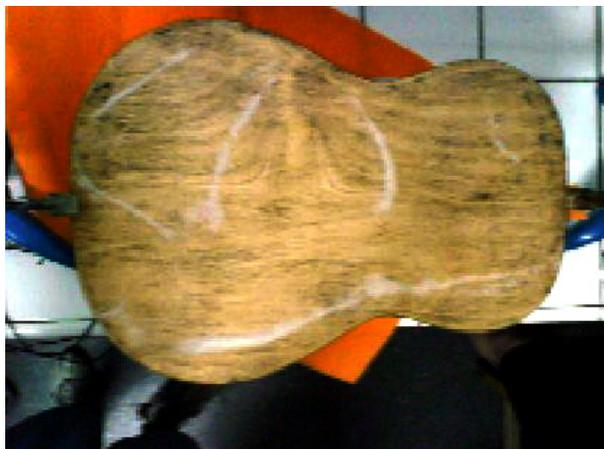
2.17 : Figures de Chladni sur une caisse de résonance de guitare acoustique.
