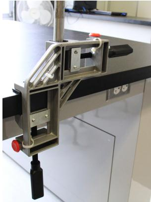
3.61 : Serre à angle utilisée pour fixer la tige à une table.
